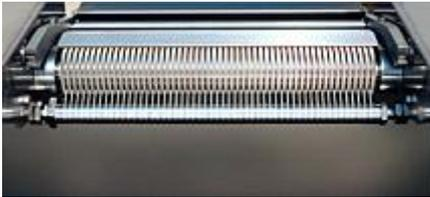
Las máquinas peladoras de pescado automáticas NOCK Cortex CBF y las máquinas peladoras abiertas NOCK Cortex CF están equipadas con un **rodillo transportador dentado con ranuras**. Un **peine rascador** corta en las ranuras del rodillo dentado para mantenerlo limpio durante el proceso.
